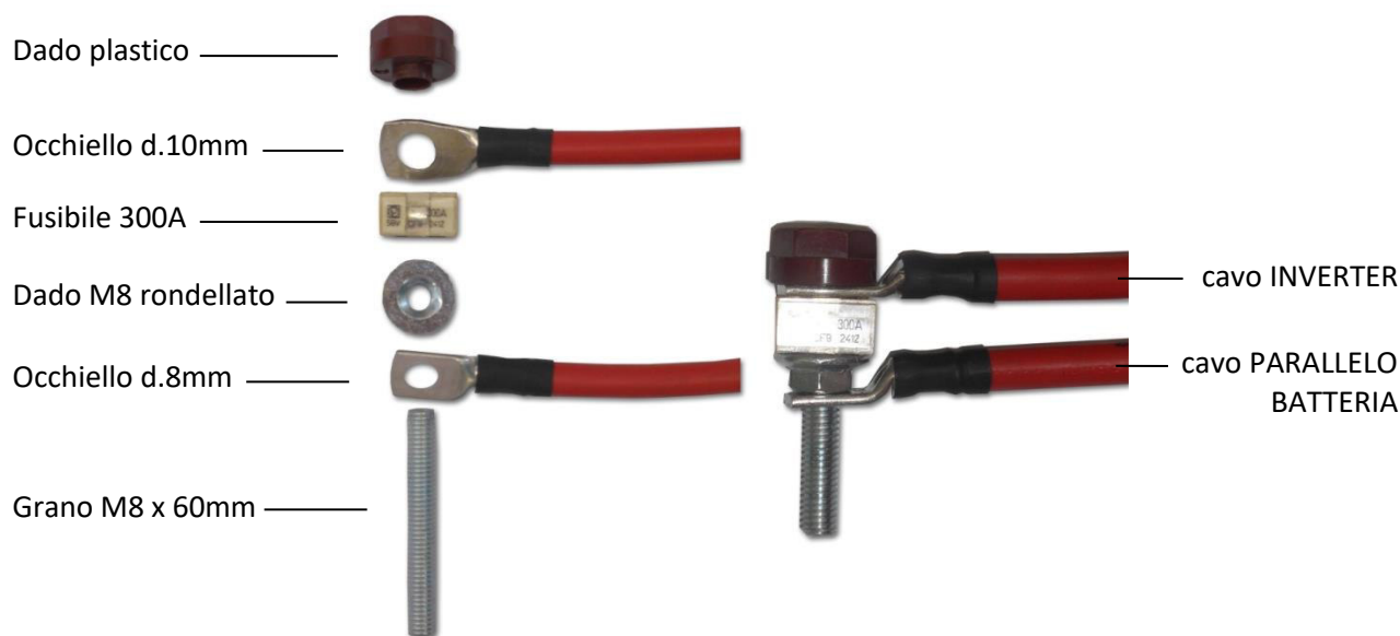
Fig.5 Fusibile di Protezione
