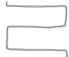
3. Das Modul nicht stärker als 13% der Länge biegen. Die Höhe "h" darf nicht größer sein als 13% der Länge des Moduls. Siehe auch Diagramm
