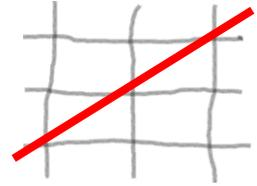
Durch Verkleben in Serpentinaen kann Wasser entweichen. Der Abstand der Kurven sollte ca. 8 bis 12 cm betragen. Die Windungen sollten über das Modul von einer Kante zur anderen gezogen werden. Die Windungen sollten das Modul von oben nach unten abdecken.
